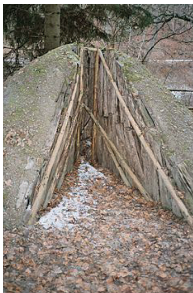
Faszénégető boka keresztmetszete
